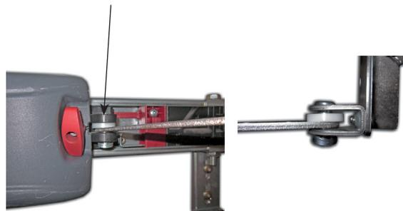
Le bras doit être parfaitement horizontal, si ce n'est pas le cas régler la position du rail moteur
