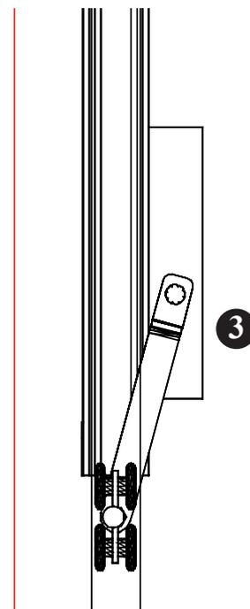
**2 - Ecoinçon supérieur à 600 mm** ( dans ce cas le dernier panneau est équipé d'un bras articulé )
