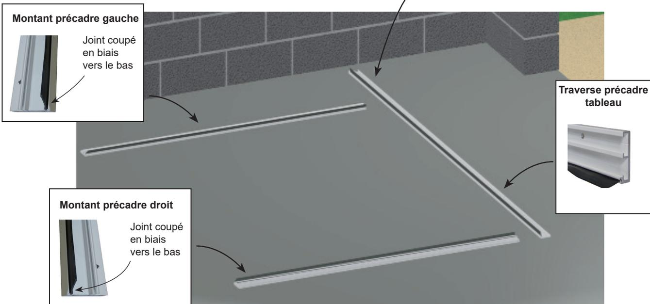
2 - Assembler les 3 éléments ensemble avec 4 vis 4.8\*100 en fonction des préperçages de la traverse
