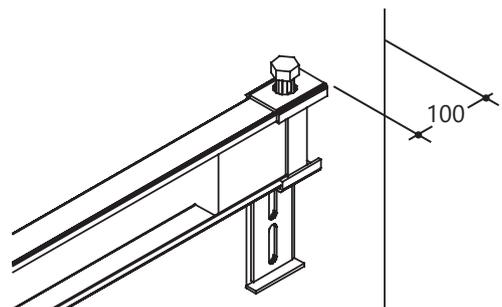
L'extrémité du rail se trouve à **100 mm** du mur et le haut du rail à **35 mm** du bas du précadre
