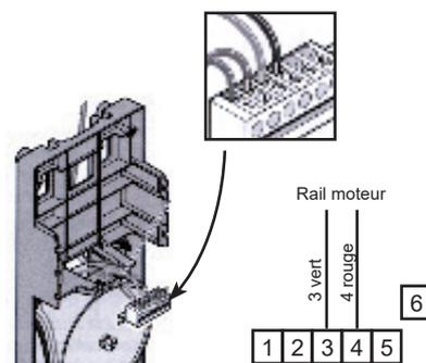
Connectez le rail moteur au bornier
