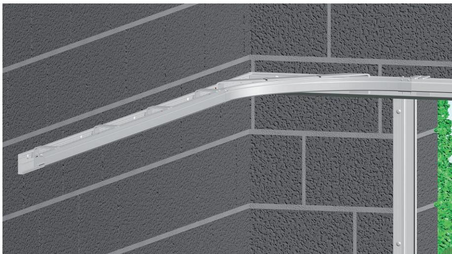
Positionner le rail en butée sur les équerres et les vis de réglage et bloquer le avec les vis fournies
