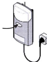
Appuyez sur le bouton central du boîtier, la porte s'ouvre jusqu'au contacteur de fin de course puis l'ampoule clignote.
