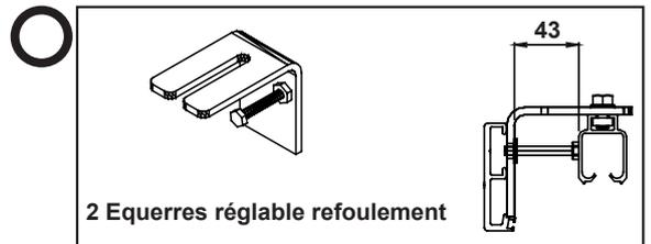
Positionner les équerres suivant les préconisations ci-dessous et bloquer les
