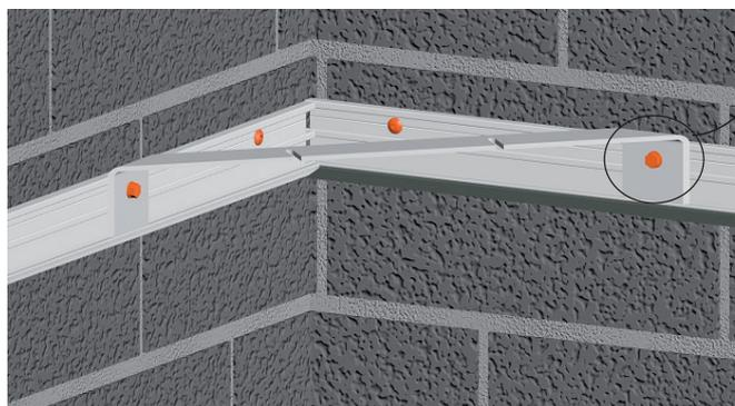
Positionner sur le support de cintre 2 vis M8, 2 rondelles et 2 clameaux
