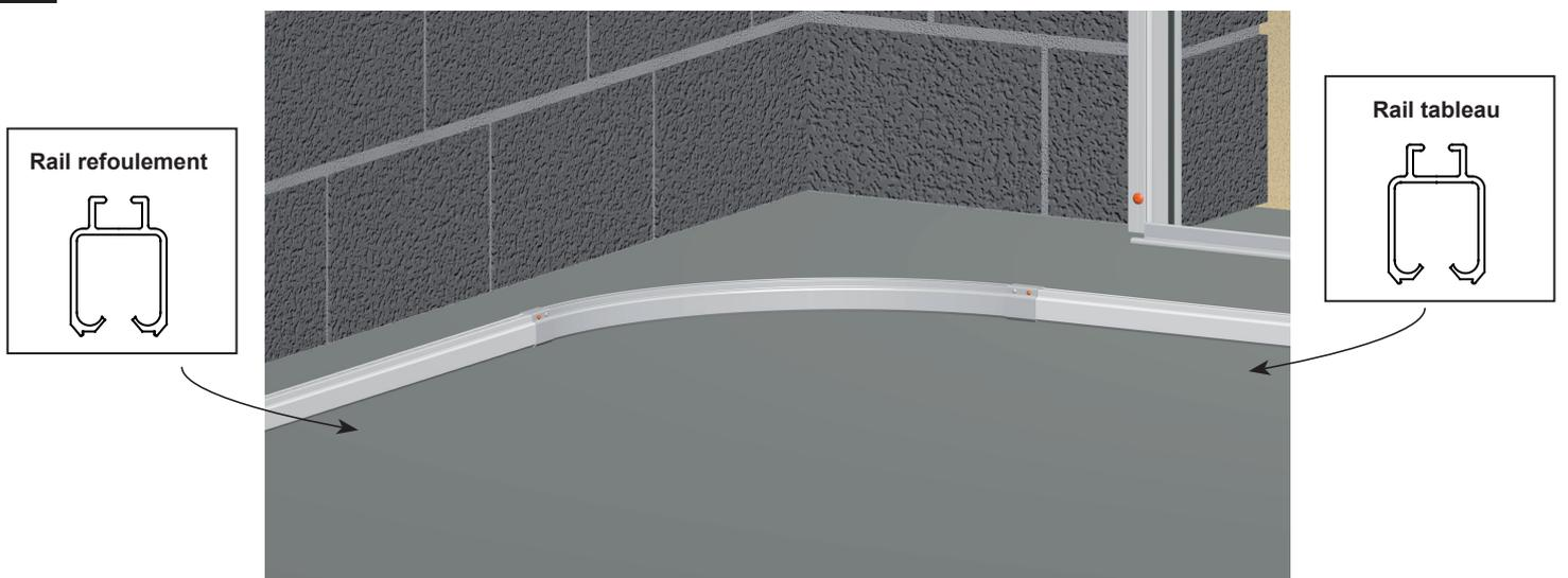
Poser le cintre aluminium , le rail refoulement et le rail tableau au sol
