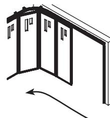
La porte doit manoeuvrer en ouverture, si ce n'est pas le cas, inversez les fils du bornier comme indiqué ci-dessous.
