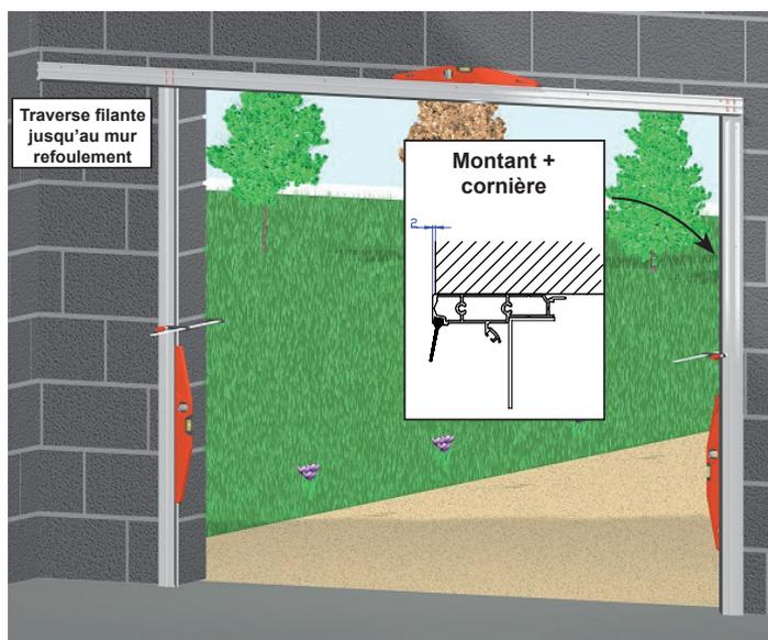
**!** Le précadre doit être parfaitement d'aplomb et de niveau
